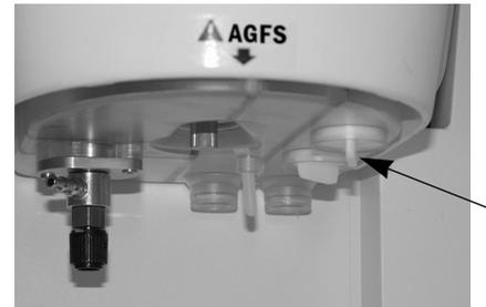
3. Zur Anpassung der Flowrate das Nadelventil verwenden. Bei Einstellung der Flowrate auf den Indikatorbeutel achten. Nur ein korrekt aufgeblasener Beutel weist auf ausreichenden Flow hin.
